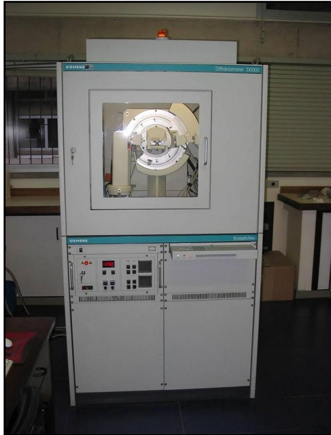
Figura 8. Difratorômetro Siemens Bruker Axs, modelo D5000 do Laboratório de Difratorometria de Raios X do Instituto de Geociências de UFRGS.
