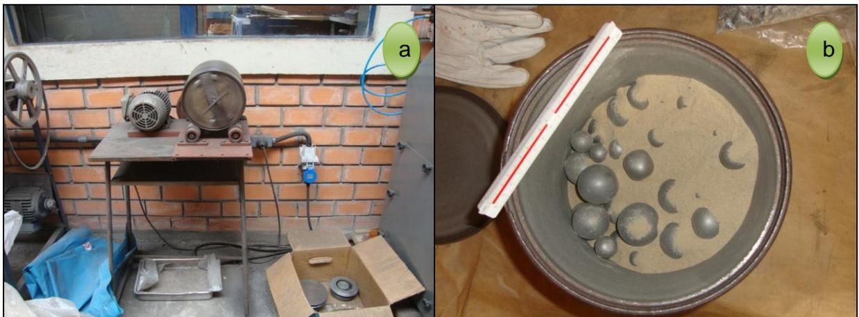
Figura 6. a) Moinho de bola utilizado para pulverizar as amostras de rochas. b) Cuba onde são colocadas as amostras de rocha e areia de construção para higienização do recipiente.
