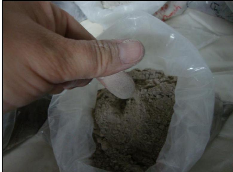
Figura 7. Amostra de pó de rocha com granulometria menor de 200 *mesh*.
