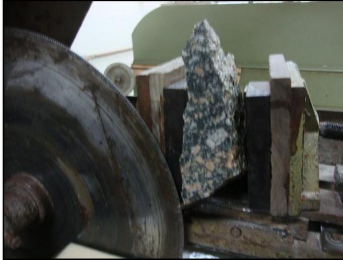
Figura 2. Amostra do granitóide submetida ao corte para o preparo da lâmina delgada.
