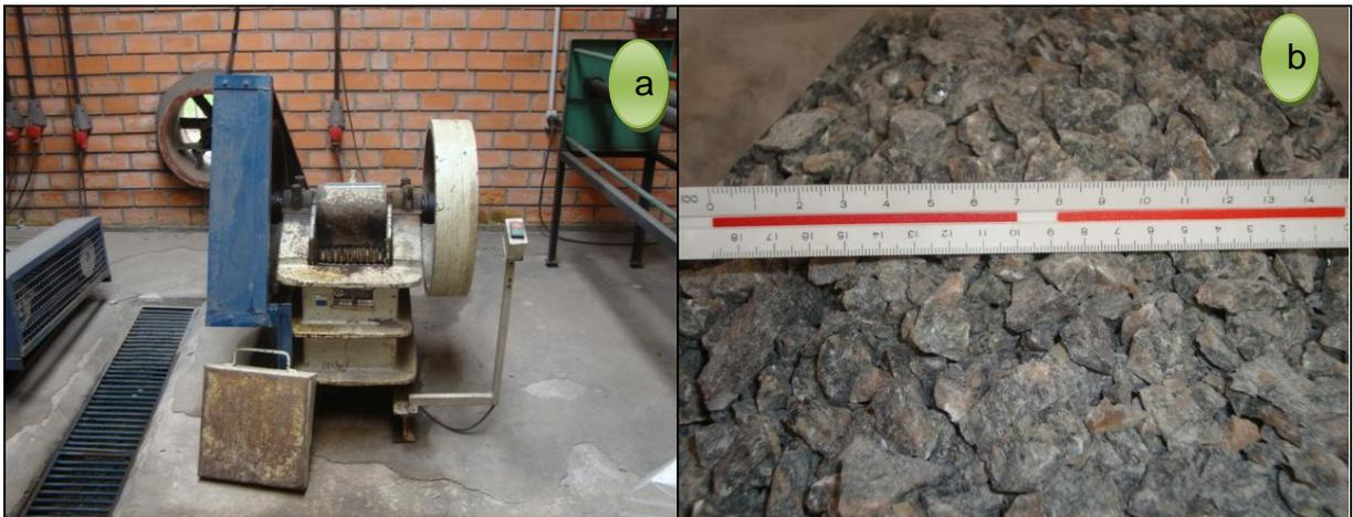
Figura 5. a) Britador de mandíbula Plangg do Laboratório de Processamento Mineral e b) Rocha britada com granulometria de até 3 cm.
